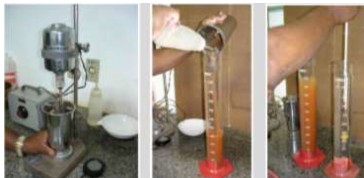
Figura 4: Ensayo de sedimentación: aparato dispersor, transferencia del suelo disperso para la probeta de 1 lt y homogeneización de la temperatura del densímetro (Fuente: Neves et al, 2009).
