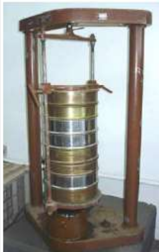
Figura 1: Ensayo de tamizados: Serie de tamices recomendada y equipo electrónico de tamizado (Fuente: Neves et al, 2009)
