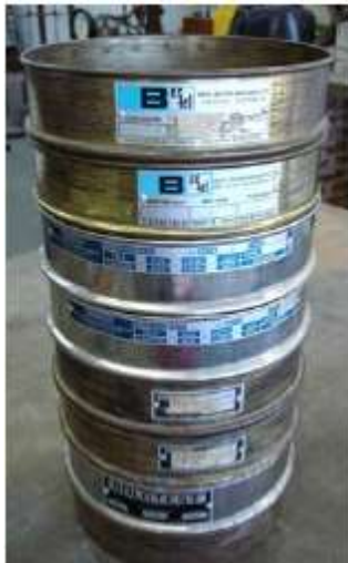
Figura 1: Ensayo de tamizados: Serie de tamices recomendada y equipo electrónico de tamizado (Fuente: Neves et al, 2009)
