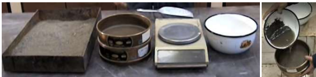
Figura 5: Instrumental para ensayo de lavado del material fino por tamiz 75 \mu\text{m}
