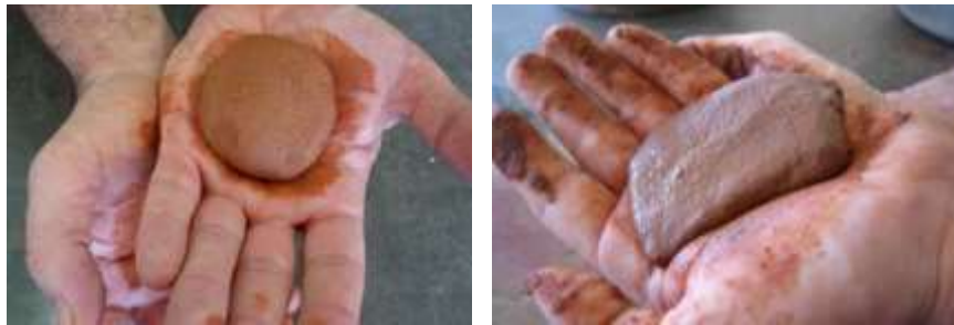
Figura 8: Ensayo de exudación
