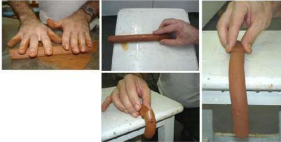
Figura 10: Ensayo del rollo para verificar la aptitud del suelo para ser empleado en muros de tapia o BTC
